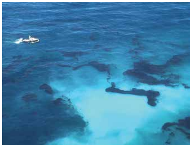
▲ 図5：重油への油処理剤散布が効果的でない場合の特徴として、水中に白い羽が現れる。油は油処理剤の作用を受けていない。
