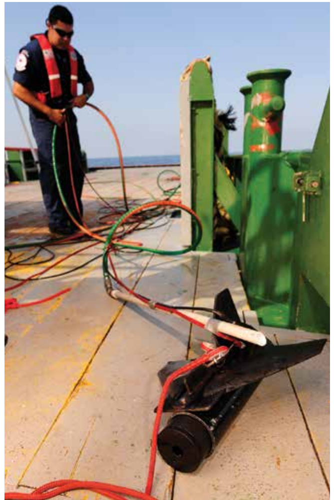
▲ 図13：海上での油処理剤の有効性を計測するため、曳航蛍光光度計を準備する。(画像提供：USCG)
