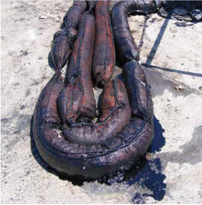
▲ 図14：回収した吸着型オイルフェンスから染み出した油は、二次汚染源になる。
