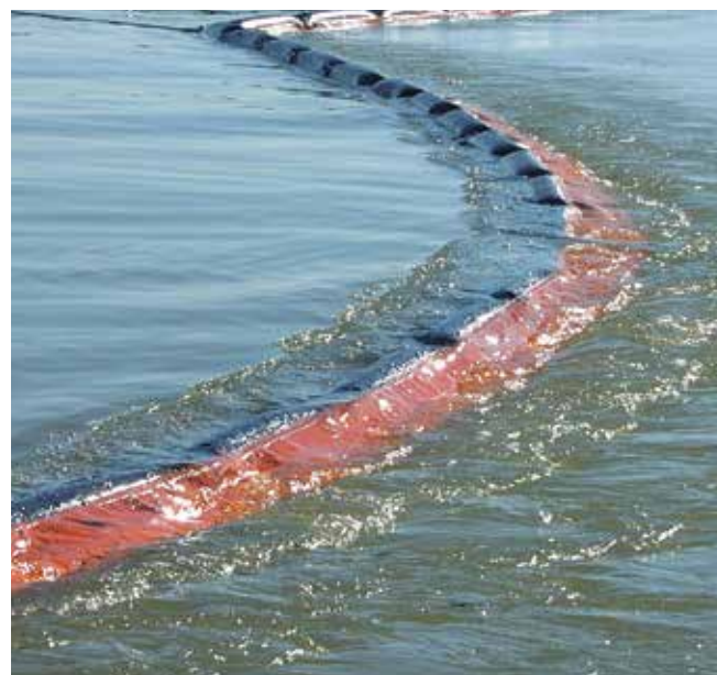
▲ 図4：強い海流によってオイルフェンスが浮上して横倒しになり、スカートの下から油が漏出した。
