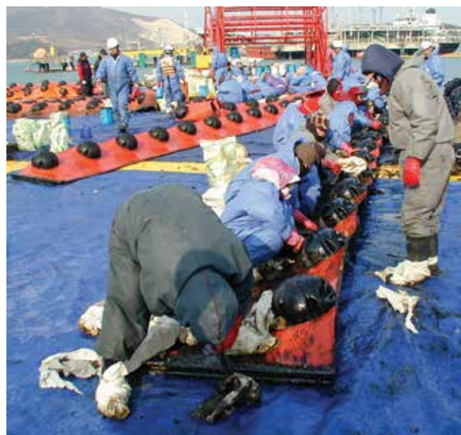
▲ 図6：衝立型オイルフェンスの外部浮体の裏側に付着した油は、特に掃除が難しい。
