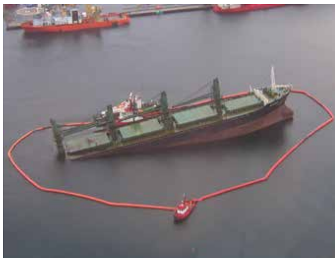
▲ 図12：漏出の恐れのあるバンカー燃料を封じ込めるために、沈みかけた難破船の周囲に係留された充気式オイルフェンス。
