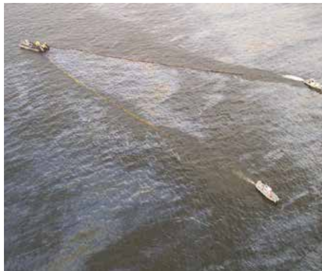
▲ 図9：先端部に別の油回収船を配置して、2隻の曳航船によってV字形に展張されたカーテン型オイルフェンス
