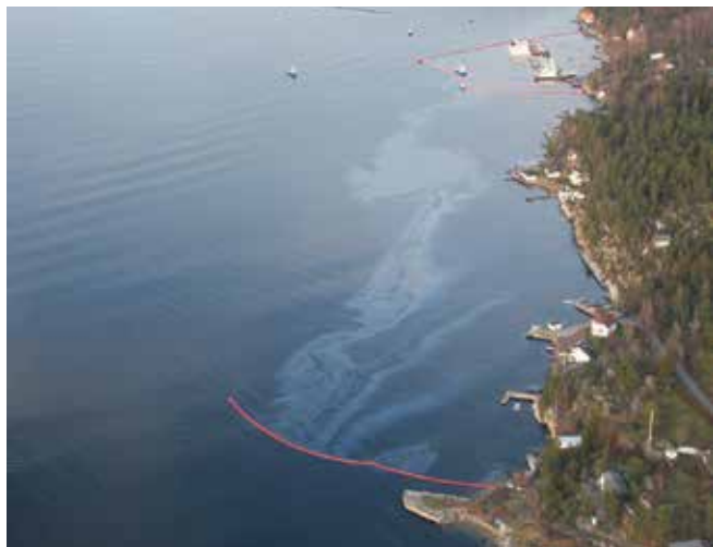
▲ 図14：回収するために、油を海岸方向へ進路変更させる小突堤として使用されているオイルフェンス (©ノルウェー沿岸管理局)
