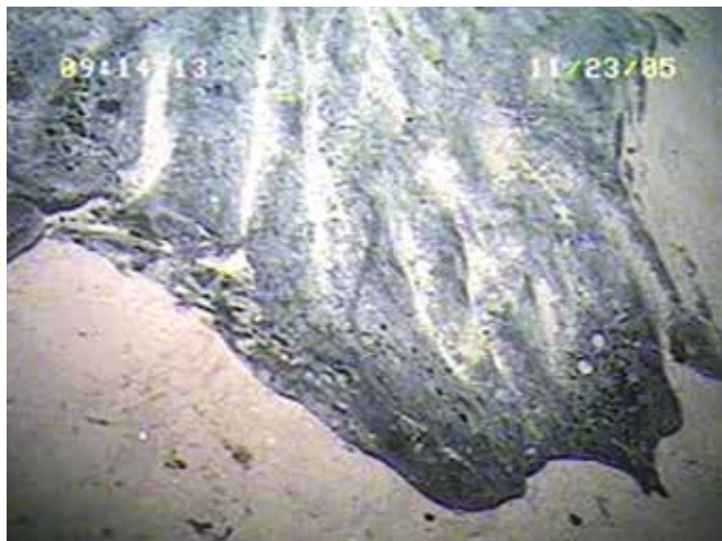
▲ 図11：損傷したバージから流出後、海底に沈んだ超重質重油。API比重は4、比重に換算すると1.04である。海水の比重は1.025である（画像提供：NOAA）。
