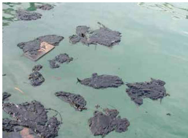
▲ 図3：流動点以下の温度の海に流出した油は、半固体の断片を形成する。この写真は、28°Cの海水中の流動点+33°Cのナイール・ブレンド原油を示す。このような油は持続性が高く、長距離を移動する場合がある。
