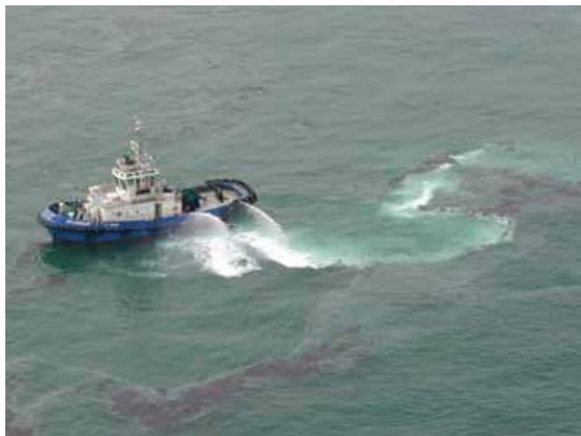
▲ 図14：油の粘度が高いため油処理剤の散布が失敗に終わった例。油の周囲にある典型的な白い羽毛状の油処理剤に注意。
