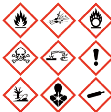
▲ 図7: HNS表示のためのGHSの絵文字。左から、可燃物、爆発物、酸化性物質、急性毒性物質、腐食性物質、有害物・刺激物、環境有害性物質、発がん性物質・感作性物質、そして高圧ガス。これらは国及び地域のラベルの代わりに使う目的で作られている。
