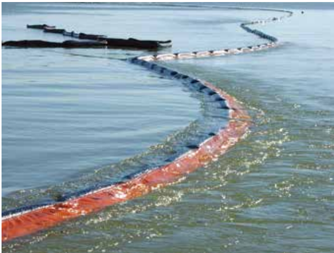
▲ 図4: 資機材やそれらが配置される環境の制約を十分に把握しておくことで、効果がないことが予測される活動に時間や労力を無駄に使わなくて済むようになる。この写真では、海流が速いとオイルフェンスは油を包围できないことがわかる。
