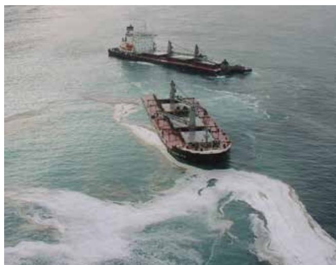
▲ 図13：バラ積み船の壊滅的な損傷の結果、C重油が流出した。貨物が油と混じり、流出油の容量を現実的に推定し決定することが困難になった。
