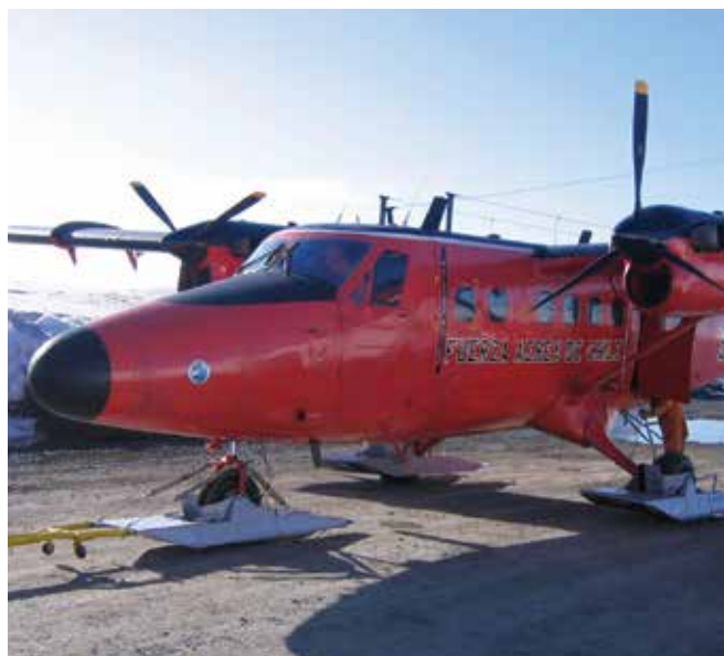
▲ 図2：高翼式双発固定翼機は、海上の油の空中監視にとって最適なものである。海岸近くでは、優れた操作性と低速のゆえにヘリコプターの方が望ましい場合がある。
