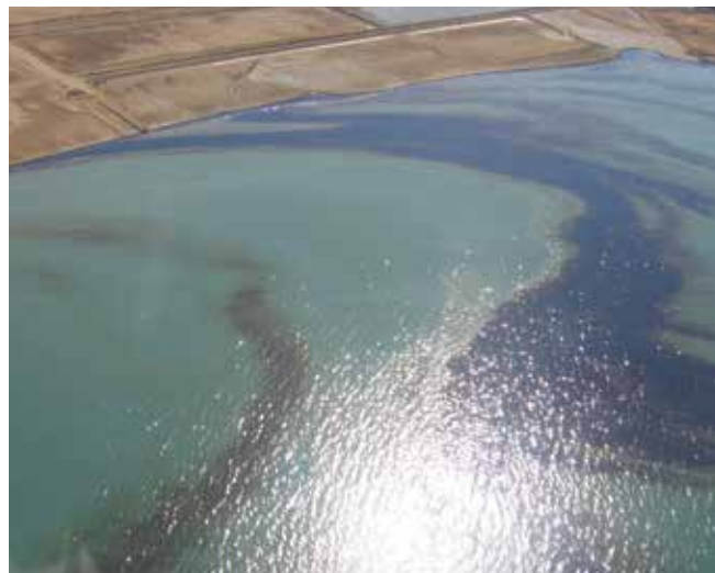
▲ 図21：海面からの光反射が、航空写真撮影の障害になる場合がある。UVフィルター及び偏光フィルターは油を鮮明に撮影するために役立つ場合がある。
