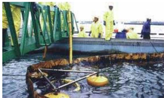
造波プール内に油を投入し、波のある海でのスキマーによる回収方法・効率の確認
