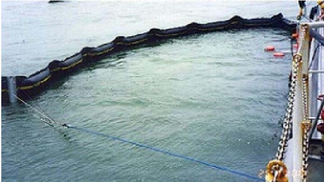
オイルフェンス、巻取リール、油圧ユニット（リール巻取機、ブローア（空気注入・吸引可）で構成されており、通常はコンテナに収納されている。使用時には、油圧ユニットを始動させ、リールを巻き出しながら、空気を注入することが可能。また、船に取り付けられ、舷側で J 字フォーメーションによる集油システムが可能である。空気注入口は、逆弁となっており、空気注入が容易。
