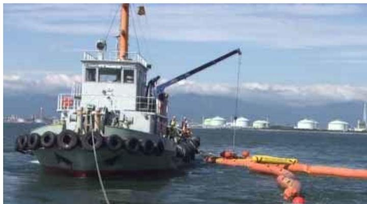
図Ⅲ. 3 油回収装置に必要なクレーン
