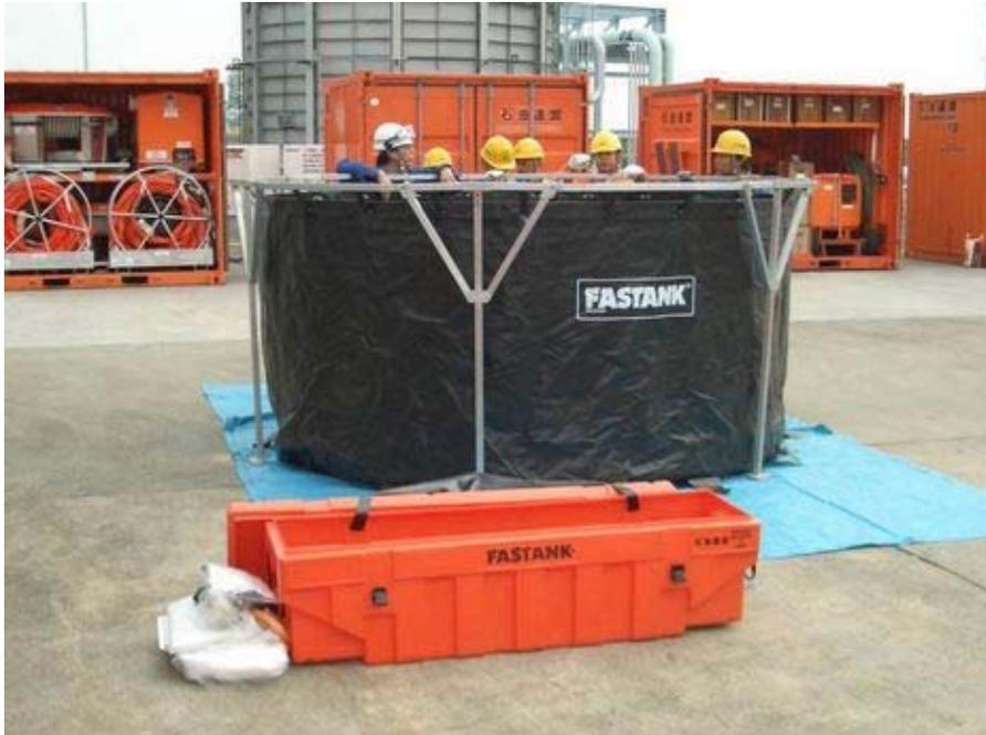
保管場所をとらず、組立も簡単にできる、回収油の貯蔵タンク。 船上でも回収用タンクとして利用できる。
