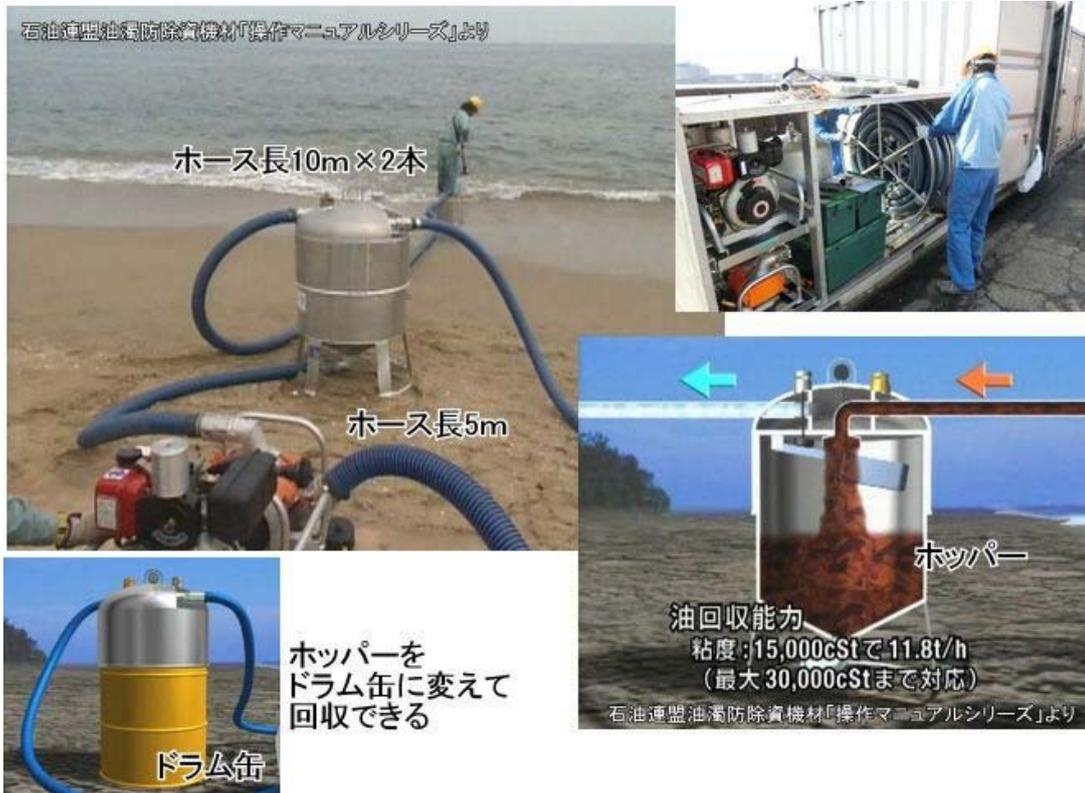
ミニバックシステム兼移送ポンプシステムは、岩場や砂浜など海岸線に着した高粘度の油（15,000cStの粘度の油を11.8t/時で回収、最大30,000cStまで回収可能）や固形物を吸い込み回収する。
