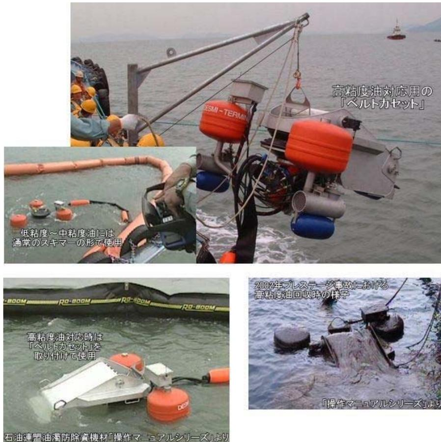
従来のデスミスキマーを改良し高粘度油回収用の「ベルトカセット」を着脱可能にした。
