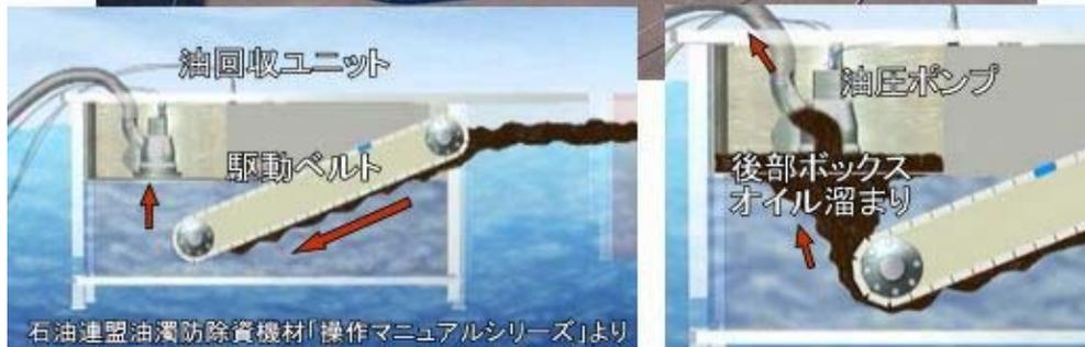
ディップ 402 スキマーシステムは、大型の油回収ユニットと集油するためのブームがセットになった油回収システム。
