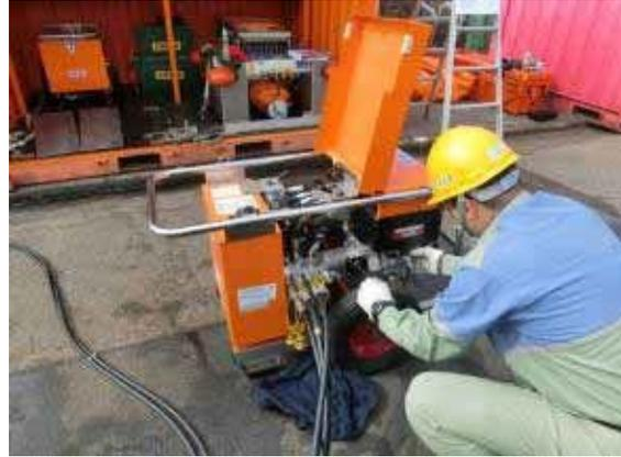
実地操作訓練 油回収機 コマラ 15 Duplexs 及びコマラスターの操作訓練
