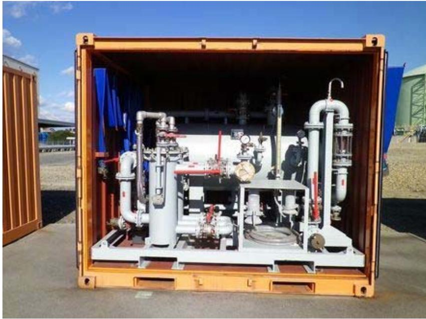
油回収機に接続して使用し、海水中に混入する 25,000cp 以下の高粘度油を、90%以上の効率で分離除去する機器。
