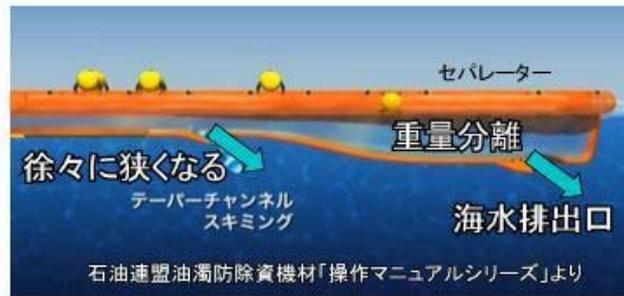
カレントバスターは、集めた流出油の余分な水分を排出し、油だけを溜める構造の「ストレージタンク」とオイルフェンスが統合されたものである。
