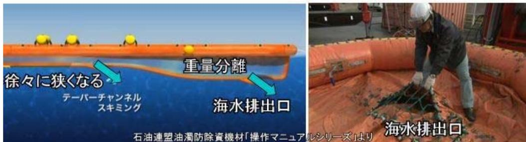
カレントバスターは、集めた流出油の余分な水分を排出し、油だけを溜める構造の「ストレージタンク」とオイルフェンスが統合されたものである。波の状態や波に対する曳航の方向によるが、1.5～4ノットの高速で集油作業ができる。
