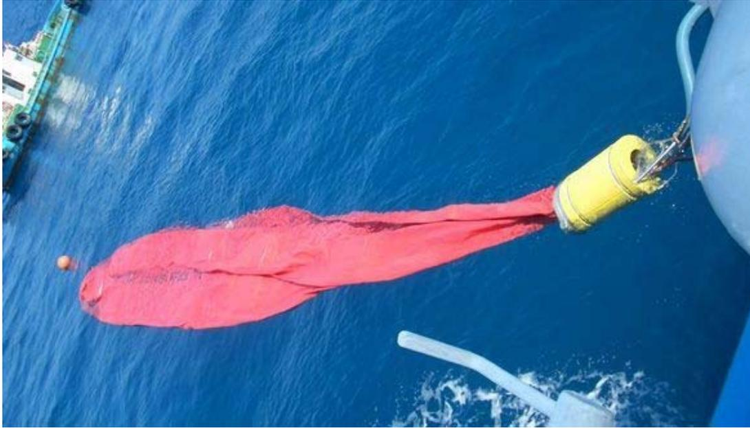
特殊合成素材で作られた大型バッグ。海に浮かべ、回収した油を移送できる。
