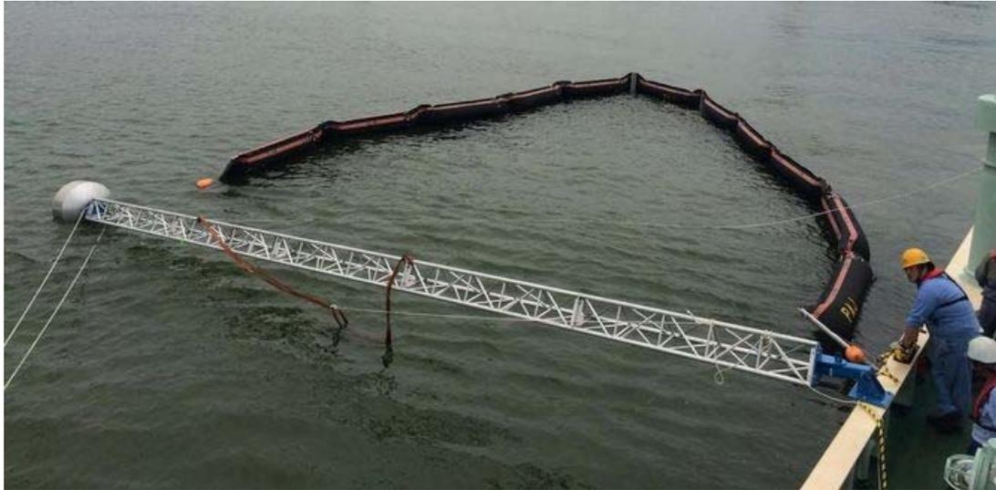
オイルフェンスの上部（フリーボード部）に空気を充填し、同下部（スカート部）にバラスト水を注入する。スカート部は2つの水室からなっており、陸上に設置しても安定性がよい。
