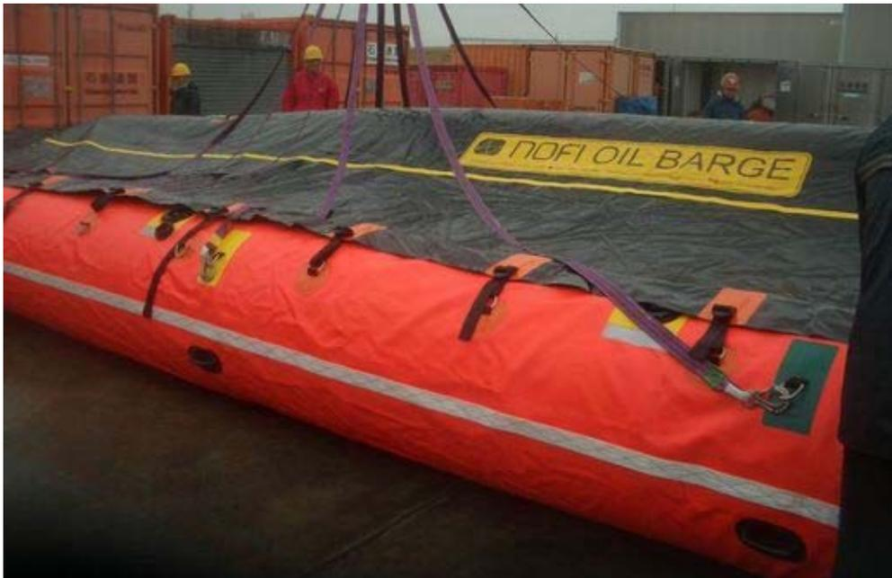
ノルウェー、ノーフィ社製のオイルバージ。回収した油を一時的に貯蔵し、小型船で回収油を運搬することが可能。17個の気室で構成されている。
