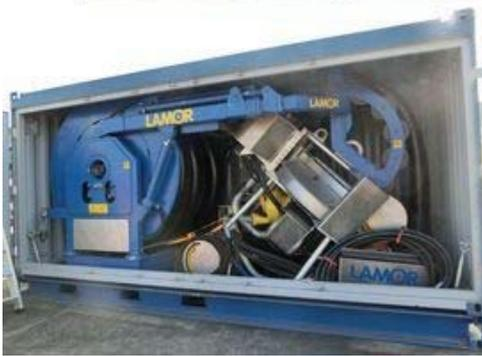
ブラシ式、堰式の2種類のスキマーヘッドを備えた回収能力 350m<sup>3</sup>/hr の大型油回収機。
