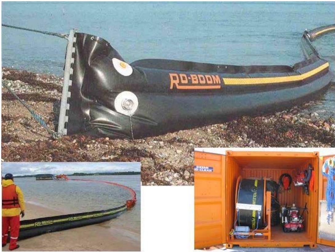
オイルフェンスの上部（フリーボード部）に空気を充填し、同下部（スカート部）にバラスト水を注入する。スカート部は 2 つの水室からなっており、陸上に設置しても安定性がよい。
