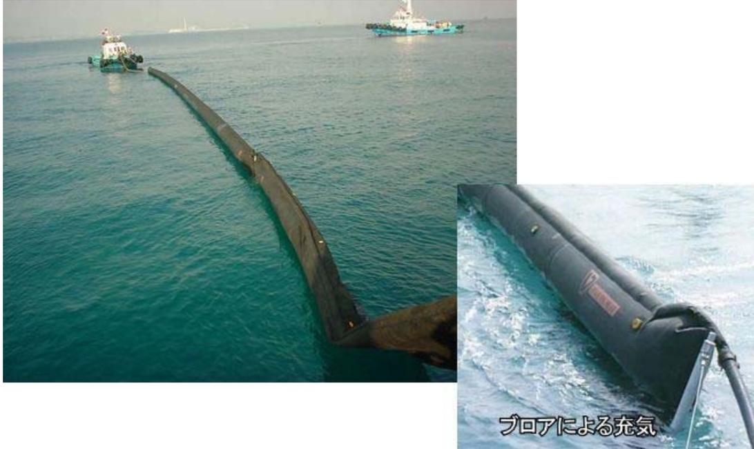
ハイスプリントブームは、ナイロンを両面にはさんだ3双のネオプレーン生地で構成され、各継ぎ目はホットバルカナイズ処理により、耐久性と品質の劣化に対する抵抗力を持つ。
