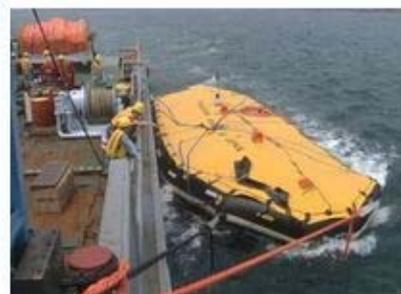
浮力チューブに空気を充填して形成した巨大な荷袋に、回収した油を一時的に貯蔵、充填し、輸送することができる大型のバージ。
