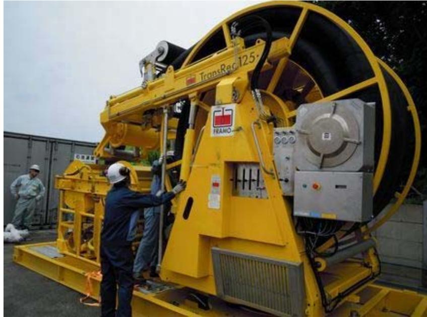
トランズレック 125 は、油圧駆動のポンプにより毎時最大 300 立米の回収能力をもつ。専用クレーンで油回収ホース類を操作する。
