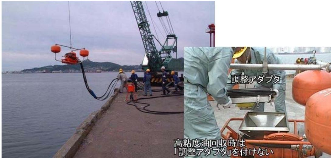
GT185-8 は、アルミフレームの付いたフロートにポンプが取り付けられているスキマーである。回収部分の「調整アダプタ」を使用し、様々な状態の流出油に対処できる。
