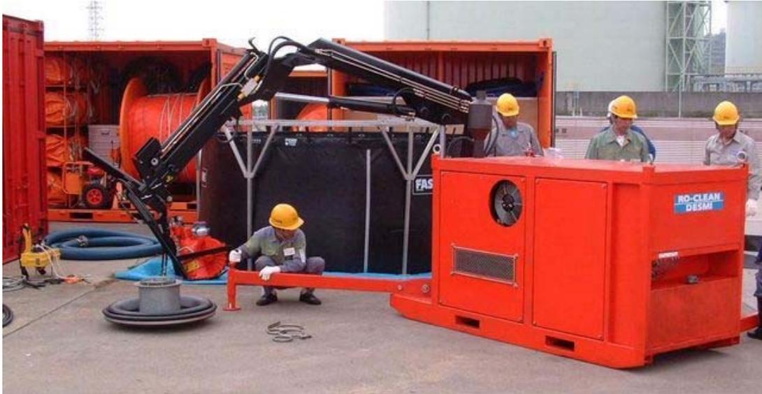
クレーン、DOP-250 型移送ポンプ、パワーパックをコンパクトに一体化したシステム。簡易回収タンクあるいは回収油ピットからの油の移送、また、海岸まで押し寄せた流出油の回収作業にも対応できる。
