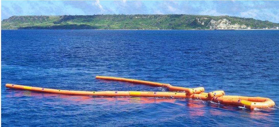
集油・回収を目的としたオイルフェンスで、2隻の曳航船により曳航し、後部の油溜りに約30klの油を集めることができる。
