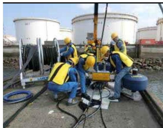
実地操作訓練 油回収機 LWS 50 の操作訓練
