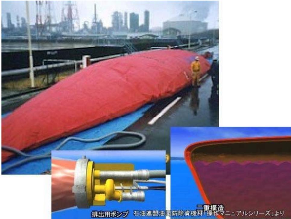
特殊合成素材で作られた大型バッグ。50kLタイプと200kLタイプがある。いずれも海に浮かべ、回収した油を移送できる。
