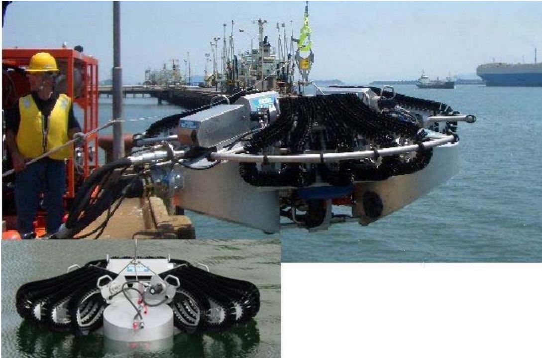
デンマーク、Ro-Clean Desmi 社の大型油回収機。
