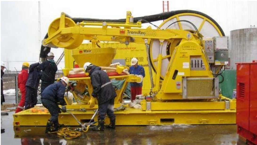
トランズレック 100 は、油圧駆動のポンプにより毎時最大 200kl の回収能力をもつ。専用クレーンで油回収ホース類を操作する。
